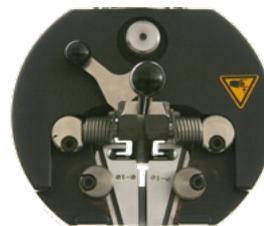
Keilspannvorrichtung bis 50 kN
