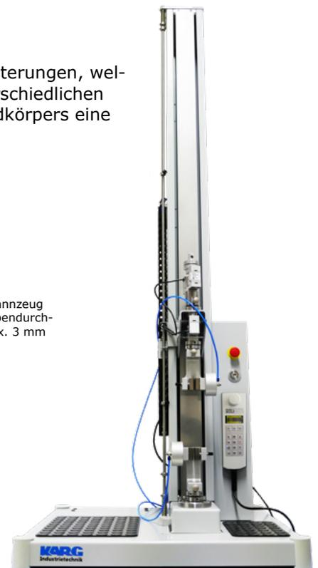
smarTens 2.5 IS-L mit pneum. Einspannvorrichtung für Folienprüfung
