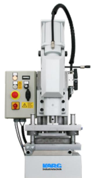
Probekörperstanze für Aluminiumproben
