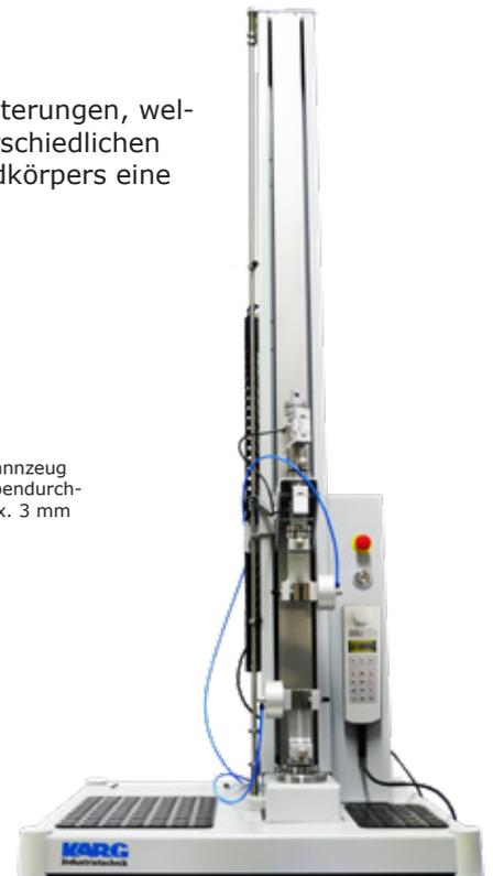
smarTens 2.5 IS-L mit pneum. Einspannvorrichtung für Folienprüfung
