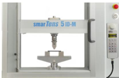
3-Punkt Biegevorrichtung montiert an einer 5kN smarTens UPM
