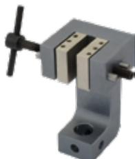
Schraubspannkopf bis 1 kN, Spannfläche 30x30 mm
