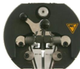
Keilspannvorrichtung bis 50 kN
