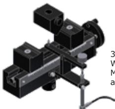
3-Punkt Biegevorrichtung mit Wegmessenrichtung für die Messung der Durchbiegung direkt an der Probe
