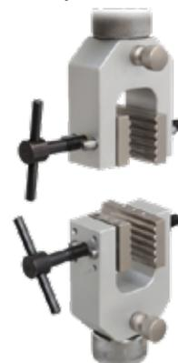
Keil-Schraubspannkopf 10 kN, Klemmfläche 45x45 mm
