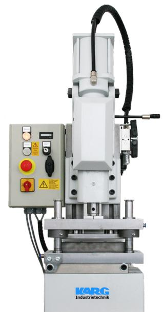
Probekörperstanze für Aluminiumproben
